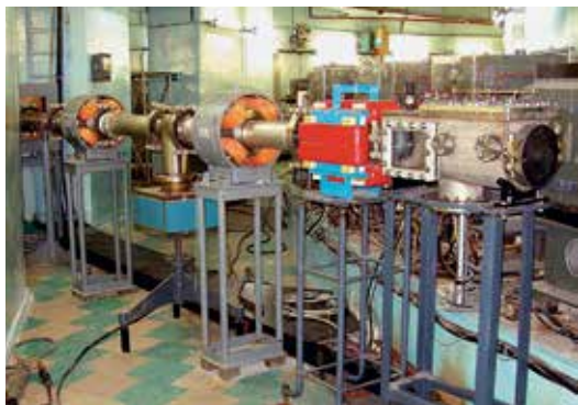
Канал перевода частиц из линейного ускорителя И-100 в бустер
