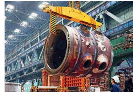
«Атоммаш». Верхний полукорпус реактора готов
